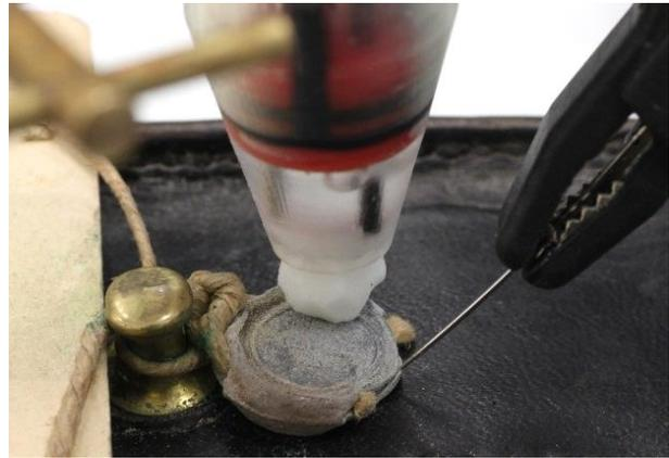
Figure 4 : Contact électrique à l'aide d'une aiguille plantée sur le côté du sceau de la pochette pour munition.
