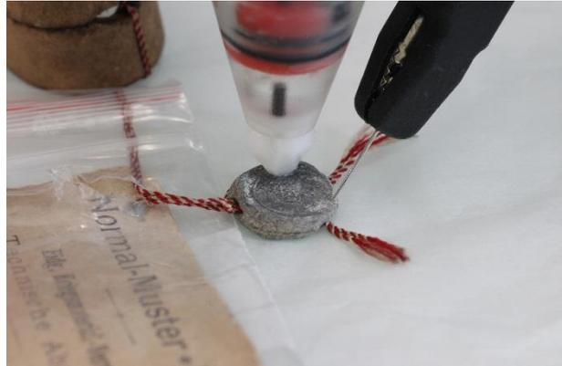
Figure 102 : Pleco sur le sceau lors de la voltammétrie.
